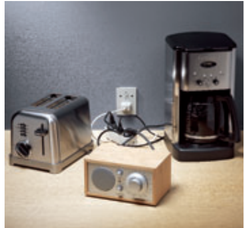
Flere kraftige maskiner er sluttet til samme kontakt. Det kan give problemer, når de bruges samtidig.
